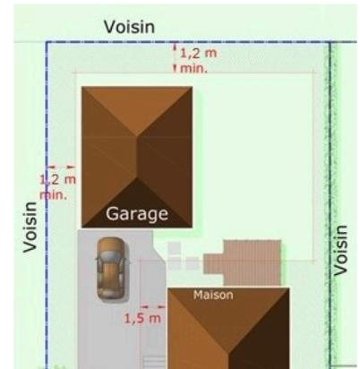
Exemple de plan d'implantation pour un garage autonome.
