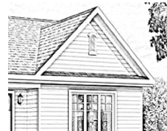
Pignon avec corniche
